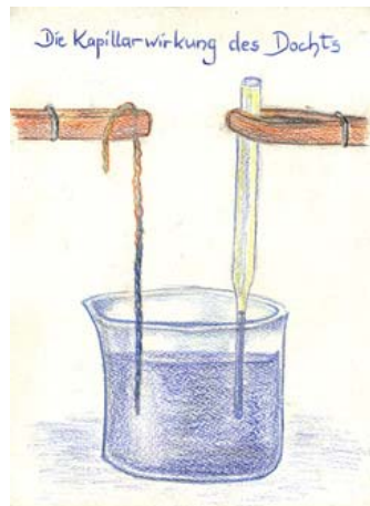
5. Die Kapillarwirkung des Dochts
